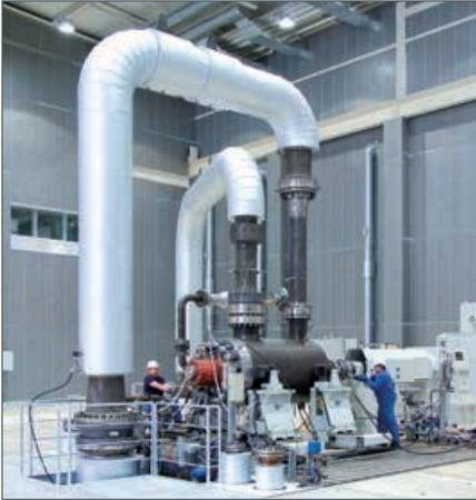
Eines der leistungsfähigsten Prüffelder für Kraftwerkspumpen aus dem Hause KSB mit einer Antriebsleistung von 20 Megawatt.
