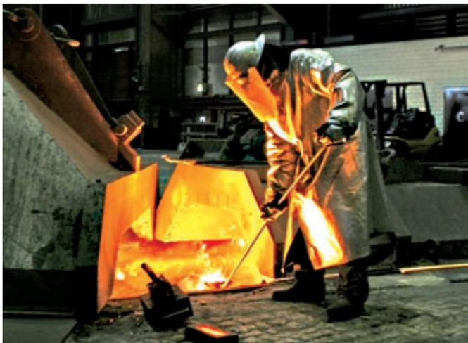
Ein Mitarbeiter der Salzgitter Flachstahl GmbH entnimmt eine Roheisenprobe am Hochofen B; Quelle: Salzgitter AG
