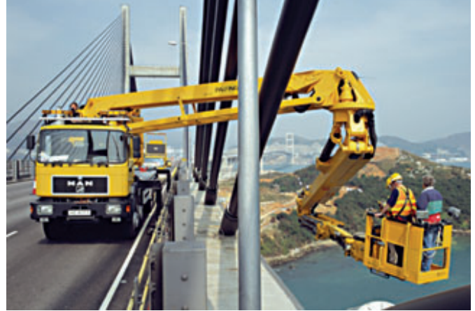
Brückeninspektionsgerät von Palfinger; Quelle: Palfinger
