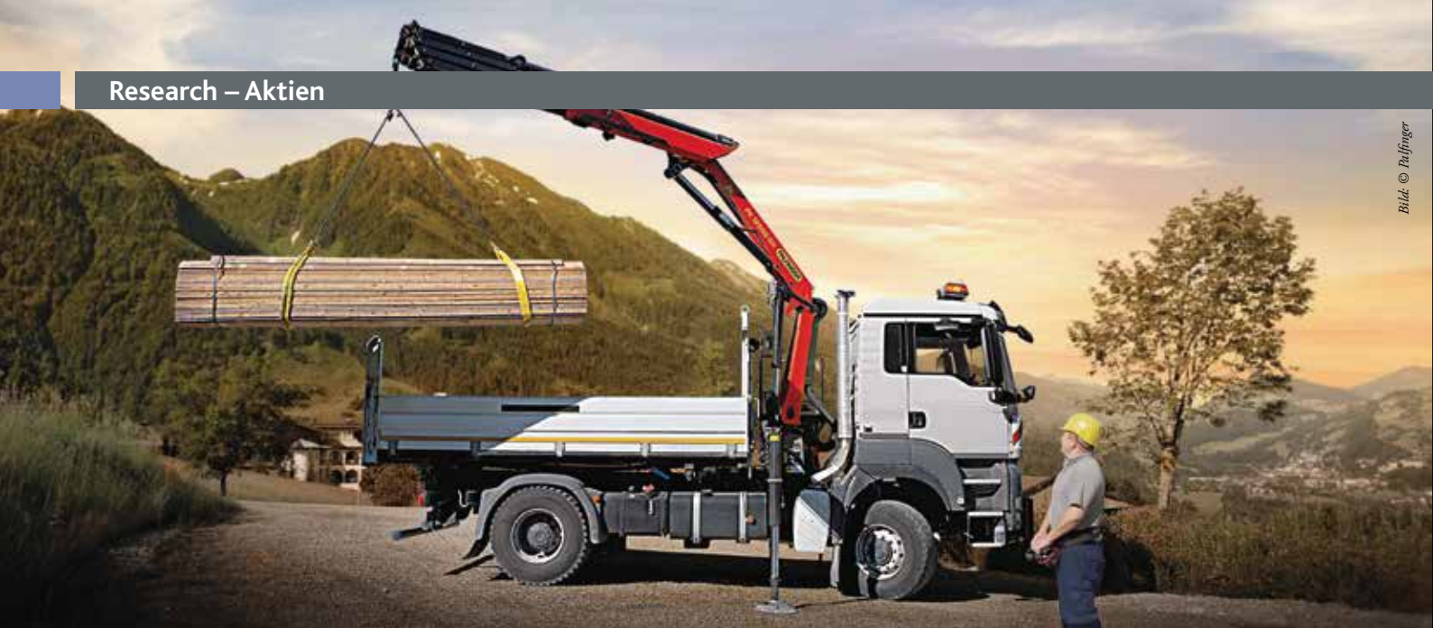
Lastwagen mit hydraulischem Knickarmkran von Palfinger
