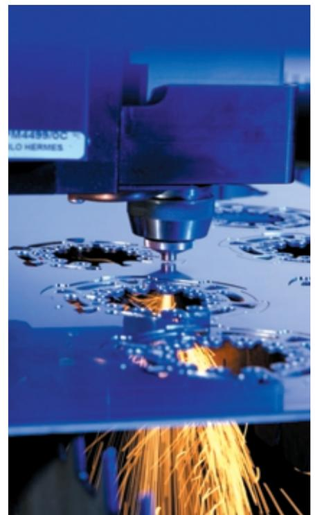
Hochgeschwindigkeitsschneiden mit CO<sub>2</sub>-Laser; Quelle: Rofin Sinar
