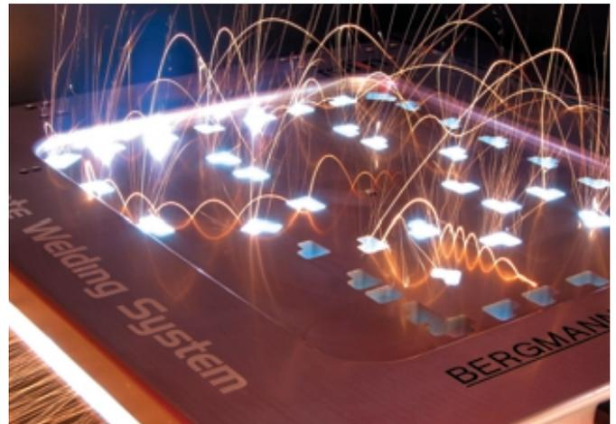
Remote-Laserschweißen von Automobilkomponenten
