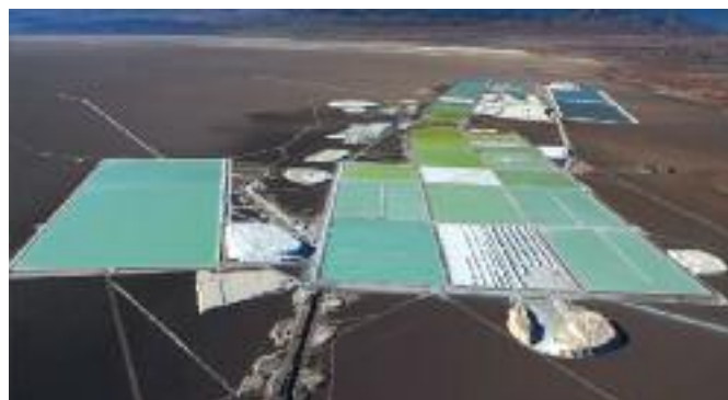
Großflächig wird Lithiumhaltige Salzlake zur Verdunstung gebracht. Das dann ausgefallenen Lithiumcarbonat kann einfach „abgerntet“ werden.
