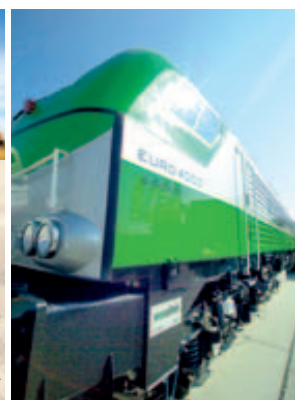
Mit der EURO 4000 bringt Vossloh Locomotives die zurzeit stärkste diesel-elektrische Lokomotive auf den europäischen Markt. Fotos: Vossloh, BNSF
